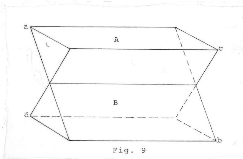
La figura 1 representa el contacto superficial de dos partes A y B en el cuerpo C. En la figura 9 se ve el contacto lineal de dos cuerpos A y B, - destacados en un cuerpo por las secciones ab y cd. En la figura 10, los dos cuerpos A y B se tocan en tre sí en un punto, siendo partes de un cuerpo que se obtienen por obra de las tres secciones abc, -- dbe, fbg.
