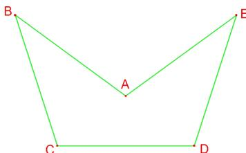
céntrese el compás en  $C$  y en  $D$ , y con radio  $\overline{CA}$  (para cuando el centro es  $C$ ) y  $\overline{DA}$  (para cuando el centro es  $D$ ), ubíquense sobre los lados  $BA$  y  $EA$ , respectivamente, los puntos  $F$  y  $G$ . Trácese los segmentos  $DA$ ,  $DG$  y  $CA$ ,  $CF$ , eliminando los lados  $BC$ ,  $CD$  y  $DE$  del pentágono, así como los segmentos  $GA$  y  $AF$ .
