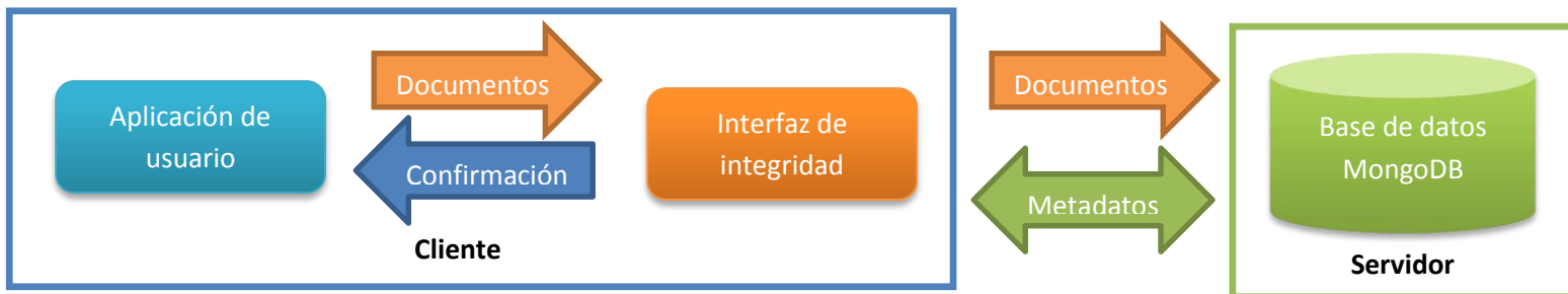
Figura 4.4. Diagrama de bloques de la interfaz de integridad y su entorno.
