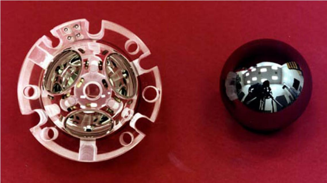
Figura 16. Giróscopos con la mayor perfección en cuanto a homogeneidad y esfericidad mecánica o eléctrica, que jamás se hayan construido (GPB, 2010). Los giróscopos funcionan levitando suspendidos eléctricamente.
