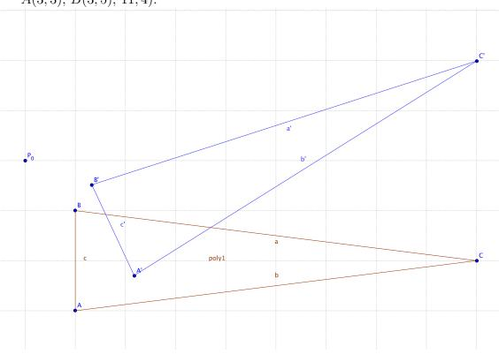
Para rotar un punto p(x,y) con respecto a  $p_0(x_0,y_0)$  obtenemos  $\tilde{p}(\tilde{x},\tilde{y})$ , la idea es sencilla, desde  $p_0$  y hacia p se forma un vector el que debe ser rotado con respecto a un ángulo  $\theta$  obteniendo el vector  $p_0\tilde{p}$  como se muestra en la figura
