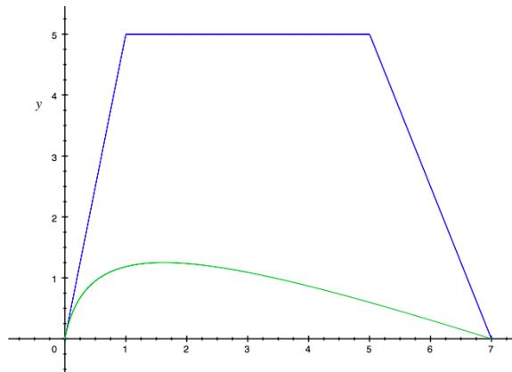
Figura 2: La curva de Bezier y su polígono de control respecto al sistema coordenado original polígono de control esta formado por el conjunto de puntos  $p_0(0, 0)$ ,  $p_1(1, 5)$ ,  $p_2(5, 5)$  y
