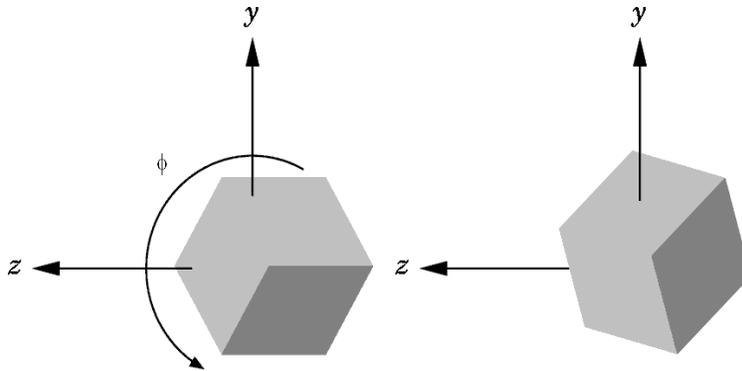
Figura 6: La rotación  $R_X(\phi)$
