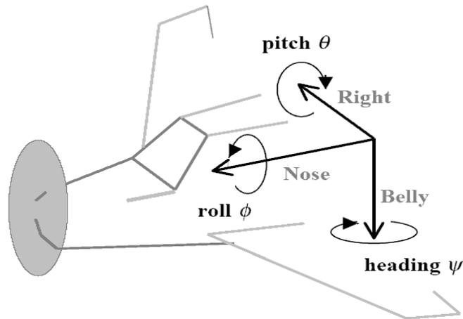
Figura 1: Un sistema coordenado local para el avión.
